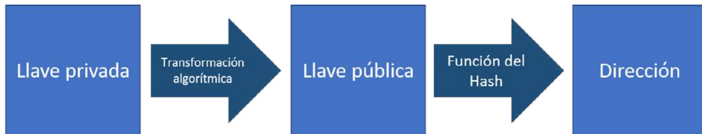
Figura 16. Flujo de transformación de las llaves en una red Blockchain. Información adaptada de Mohanty (2019).
